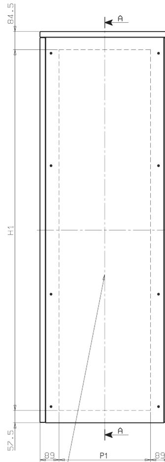
H1 X P1 ÁREA ÚTIL DE PERFORACIÓN PANEL LATERAL
