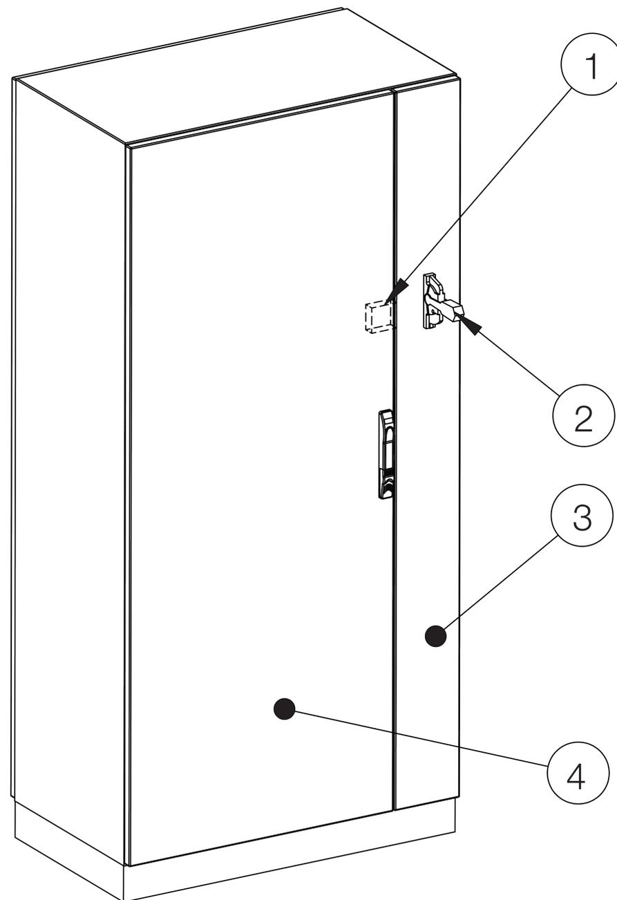
Für Schränke, die mit zusätzlichen Modulen erweitert werden, muss, um die NEMA-Anforderungen zu erfüllen, ein Kopplungsset für die Schaltschrankverriegelung verwendet werden, das das Öffnen der Nebentüren der anderen Module verhindert, wenn die Haupttür nicht zuvor geöffnet wurde. Weitere Informationen finden Sie in folgender Zeichnung:
